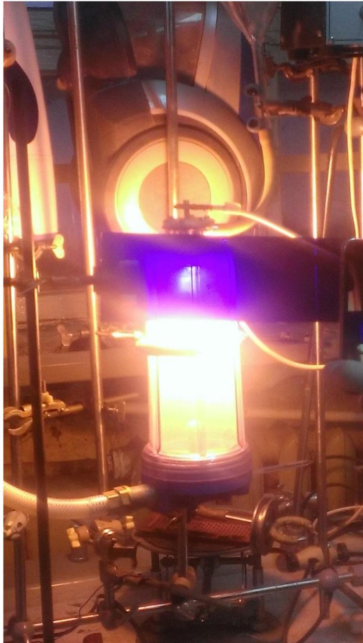
Рисунок 1 – Лабораторная установка плазменной обработки сыпучих материалов
